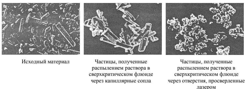
Рисунок 27 – Микронизация ловастатина распылением сверхкритического раствора (RESS-микронизация)
